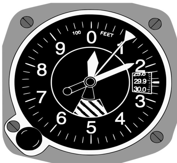
Altímetro ajustado em 29.92 pol. indicando 10.180 pés, i.e., 180 pés acima do FL 100.
